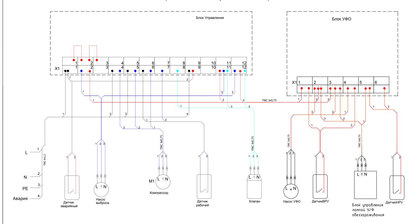
БЛОК ультрафиолетового обеззараживания (принципиальная электрическая схема)
